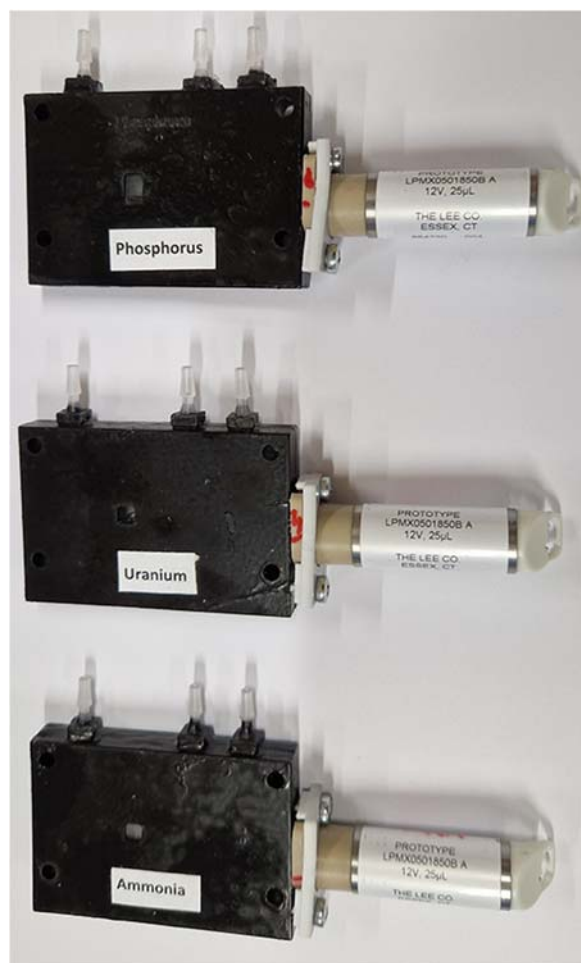
Obr. 7 Konečná podoba všech PMMA čipů před montáží do modulu.
