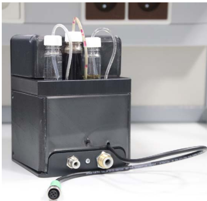
Obr. 10 Kompletní autonomní kolorimetrický modul pro detekci fosforu, amoniaku a uranu ve vodě
